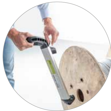
Haken Sie die Aufnehmer des CARRYGRIP in die Kabeltrommel ein.
