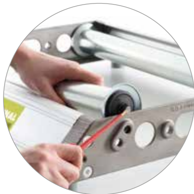
Eine einfache Verstellung der Tragwalzen durch Federkernachsen.
